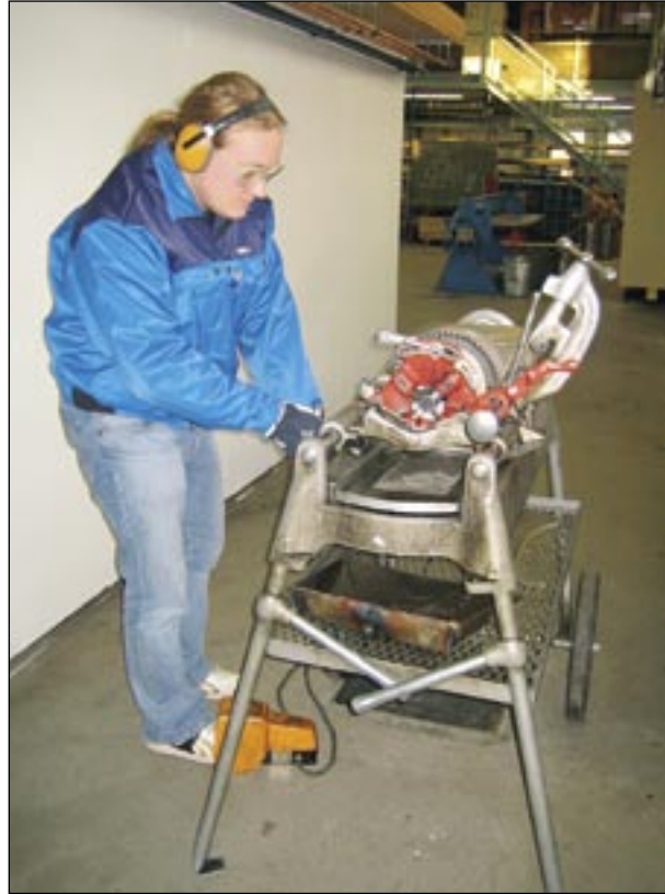
Kuva 15. Jalaksilla seisovalla kierrekoneella työskentely
