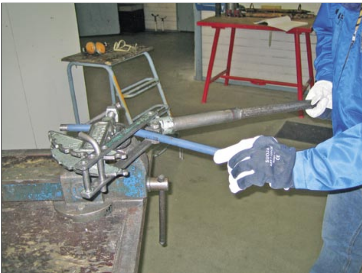
Kuva 17. Mekaanisella putkentaivutuskoneella työskentely
