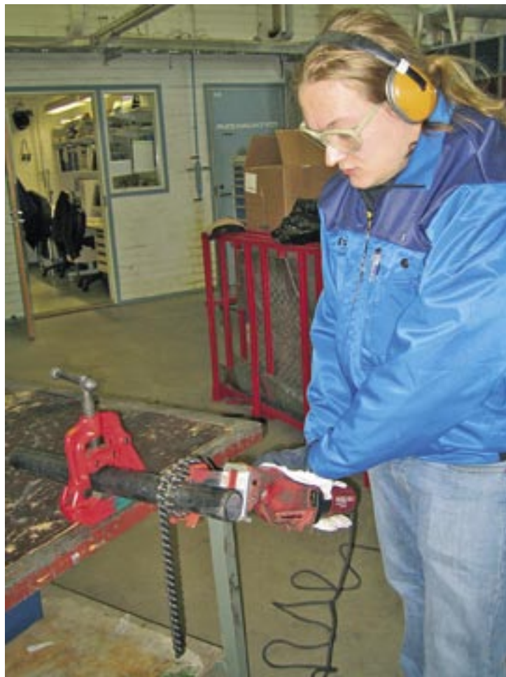
Kuva 20. Sähkökäyttöisellä sahalla työskentely
